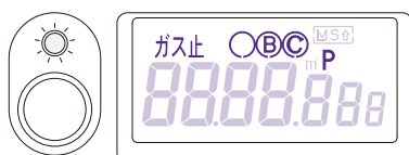
〈LED〉 2秒間隔で点滅 (24時間後に消灯) 〈LCD〉 B・C・ガス止・P 点灯
